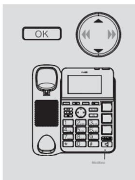
Pulse el botón OK de nuevo y utilice los botones (▲) y (▼) para seleccionar GRABAR. Pulse el botón OK y grabe su mensaje de saludo después del pitido.
