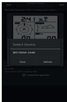
5) Si tienes más de un dispositivo, aparecerán todos en la lista. Seleccione el dispositivo. Los cuatro últimos dígitos del ID del dispositivo coinciden con los cuatro últimos dígitos de su dirección MAC. Si no encuentra el ID del dispositivo, pulse Actualizar para actualizar.
