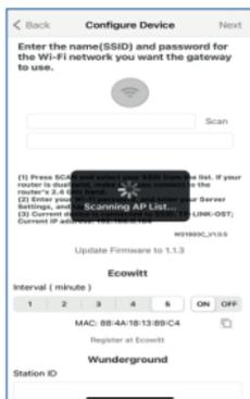
7) \*Pulse Escanear y seleccione su SSID de la lista. Si se trata de un router de doble banda y los SSID son diferentes, asegúrese de que te conectas a la banda de 2,4 GHz. Introduzca la contraseña WiFi.
