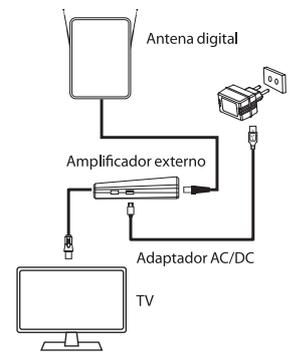
Enchufe el cable coaxial de la antena al conector ANT del amplificador externo y enchufe el cable coaxial del amplificador al conector RF de su televisor. Enchufe el enchufe de CC del adaptador de corriente al conector de CC del amplificador externo y el enchufe de alimentación a la toma de corriente.
