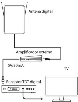
Conecte el cable coaxial de la antena al conector ANT del amplificador externo y conecte el cable coaxial del amplificador al conector ANT de su receptor digital; esto obtendrá alimentación de 5V/30 mA del receptor digital.
