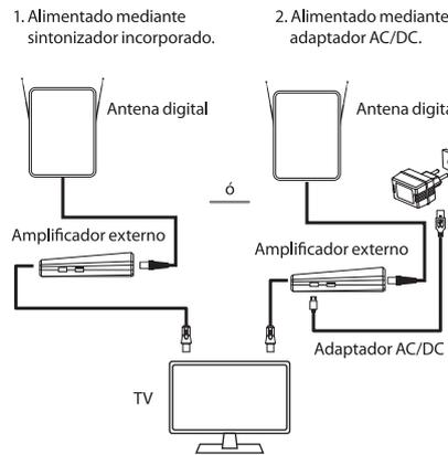
Conecte el cable coaxial de la antena al amplificador externo y conecte el cable coaxial del amplificador al conector RF de su televisor. Conecte el cable coaxial de la antena al conector ANT del amplificador externo y conecte el cable coaxial del amplificador al conector RF de su televisor. Conecte el enchufe de CC del adaptador de corriente al conector de CC del amplificador externo y el enchufe de alimentación a la toma de corriente.
