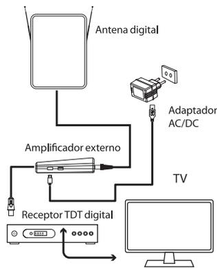
Conecte el cable coaxial de la antena al conector ANT del amplificador externo y conecte el cable coaxial del amplificador al conector ANT de su receptor digital. Conecte el enchufe de CC del adaptador de corriente al conector de CC del amplificador externo y el enchufe de alimentación a la toma de corriente.
