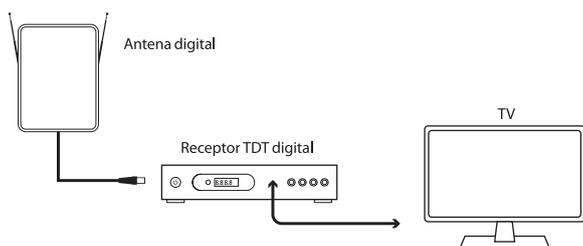
Conecte el cable coaxial de la antena al conector ANT de su receptor digital.
