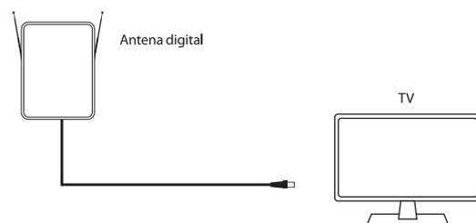
Conecte el cable coaxial de la antena al conector RF de su televisor.
