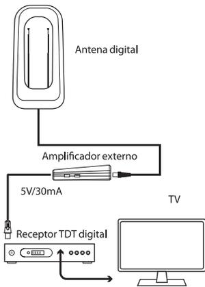
Conecte el cable coaxial de la antena al conector ANT del amplificador externo y conecte el cable coaxial del amplificador al conector ANT de su receptor digital; esto obtendrá alimentación de 5V/30 mA del receptor digital.
