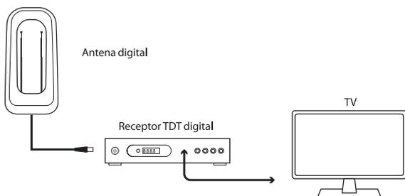
Conecte el cable coaxial de la antena al conector ANT de su receptor digital.
