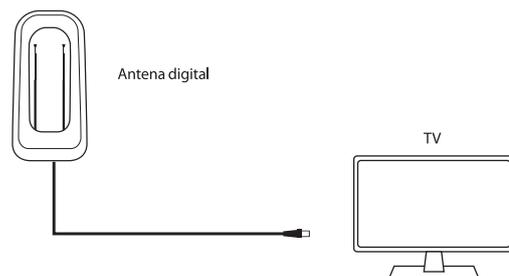
Conecte el cable coaxial de la antena al conector RF de su televisor.
