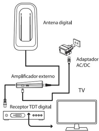
Conecte el cable coaxial de la antena al conector ANT del amplificador externo y conecte el cable coaxial del amplificador al conector ANT de su receptor digital. Conecte el enchufe de CC del adaptador de corriente al conector de CC del amplificador externo y el enchufe de alimentación a la toma de corriente.
