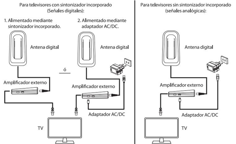
1. Conecte el cable coaxial de la antena al amplificador externo y conecte el cable coaxial del amplificador al conector RF de su televisor.
