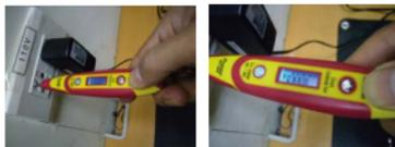
**Prueba de voltaje de CC:** presione el botón "Test de inducción" y coloque la punta de la sonda en contacto con la parte positiva del circuito, y con la otra mano sostenga o mantenga el contacto con la parte negativa del circuito pulse el botón "Test de inducción" para realizar la prueba del circuito. El indicador LED se encenderá y la pantalla mostrará los valores de voltaje.
