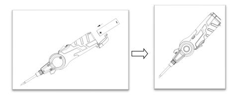
Para el primer uso, abra el compartimiento de la batería e inserte la batería (**Nota**: Asegúrese de que la polaridad sea correcta al insertar la batería, el extremo positivo hacia adentro luego cierre la tapa).
