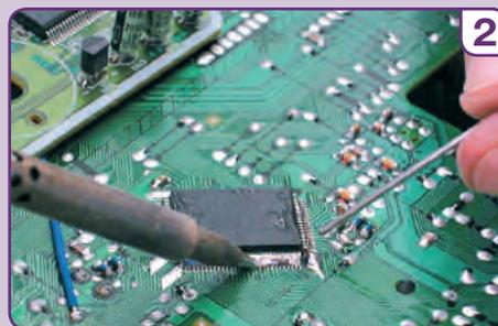
**2** Con un desoldador a baja temperatura, depositar el CHIP QUICK cortocircuitando todos los pines del circuito.
