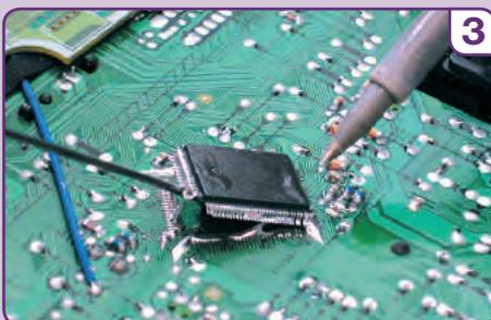
**3** Repasar todos los lados del C.I. con el soldador hasta observar que el CHIP QUICK está en estado líquido, quitar el circuito con la ayuda de un extractor.
